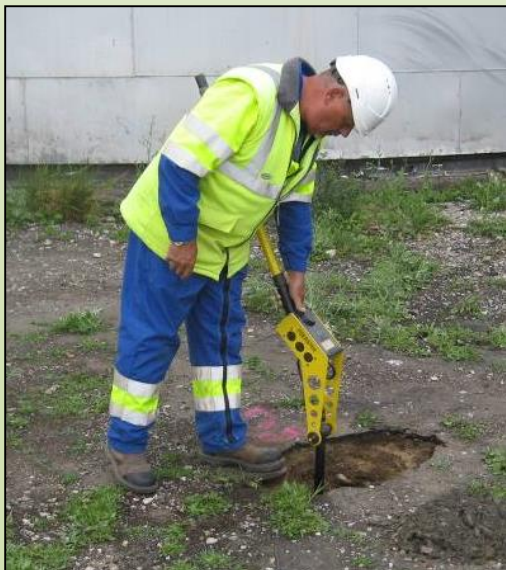
Magnétomètre fluxgate portable Ferex
