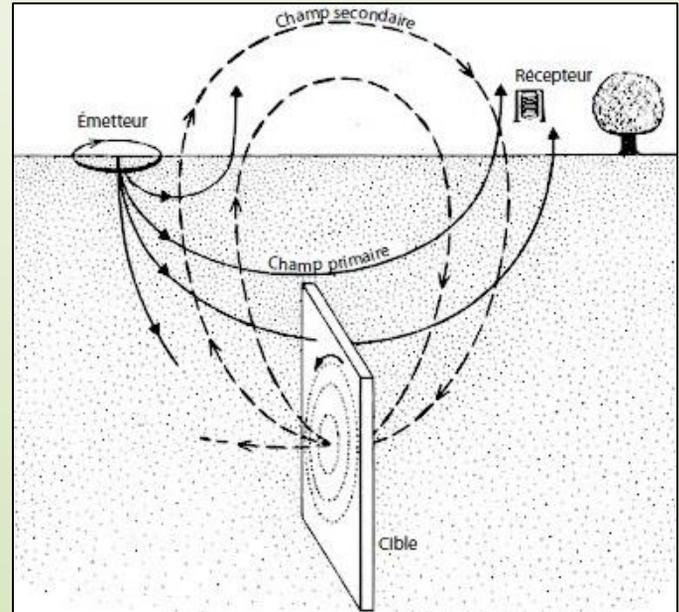
Principe de fonctionnement du conductivimètre
