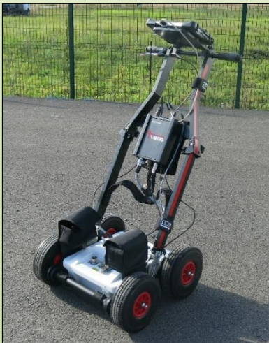
Géoradar RIS MF HIMOD (IDS) équipé d'une antenne duale 200-600 Mhz
