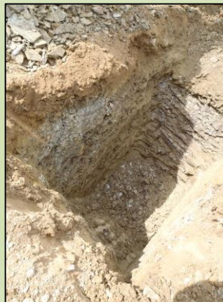
Vérification des hypothèses géophysiques par des sondages à la pelle mécanique
