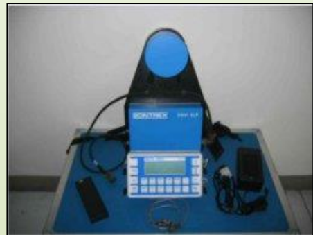
Résistivimètre électromagnétique ENVI VLF de SCINTREX
